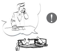
必须安装漏电保护器和专用开关;必须使用带接地的电源,并安装牢固。
