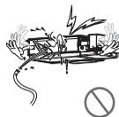
当空调器使用很长一段时间后，请检查底座等有无损坏确保安装牢固。
