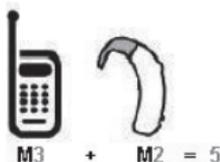
En el ejemplo antes señalado, si un aparato para sordera cumple con la clasificación de nivel M2 y el dispositivo inalámbrico cumple la clasificación de nivel M3, la suma de los dos valores es igual a M5. Esto debería proporcionar al usuario del aparato para sordera un “uno normal” al usar su dispositivo auditivo con ese dispositivo inalámbrico en particular. “Uso normal” en este contexto se define como una calidad de señal que es aceptable para el funcionamiento normal.
