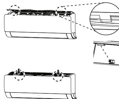
4. Provjerite bočnu stranu prednje rešetke radi pravilnog umetanja filtra zraka.
