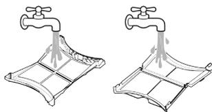
**6** Asciugare completamente i filtri antilanaugine, chiuderli e rimontarli.
