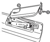
Rimuovere il coperchio della batteria sulla parte posteriore del telecomando e inserire la batteria prestando attenzione ai segni **+** e **-**.
