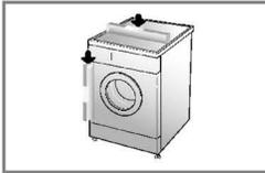
1. Mengatur tinggi mesin cuci yang tepat dapat mencegah mesin bergetar dan mengeluarkan suara berisik yang berlebihan. Tempatkan mesin pada permukaan lantai yang kokoh dan tepat. Pojok ruangan adalah tempat yang sesuai untuk meletakkannya.
