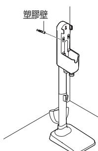
4 將充電座背面對準牆面固定模塊並用直立式專用固定螺絲將充電座固定於牆面上。
