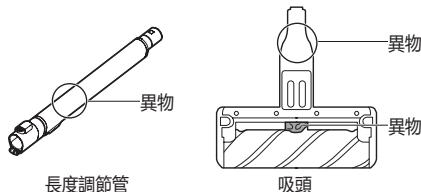
※ 如果產品內部，伸縮管，吸入口，前置濾網等被異物堵住，產品將自動關閉以保護機器。請將電池從產品拆下，並清除異物。
