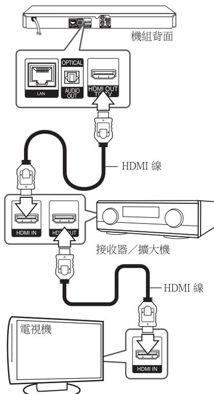
若您的擴大機有 HDMI 輸出孔，使用HDMI線連接擴大機的 HDMI 輸出孔至電視機的HDMI 輸入孔。
