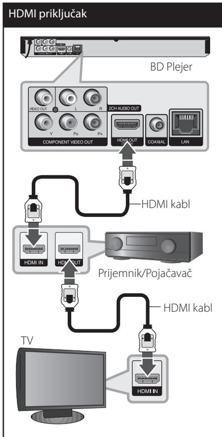
Povežite izlazne HDMI priključke pojačavača sa odgovarajućim ulaznim priključkom na vašem TV-u pomoću HDMI kabla ako vaš pojačavač ima HDMI izlazni priključak.
