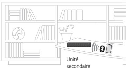
Allumez l'unité secondaire en basculant le commutateur de modes sur **PORTABLE**.
