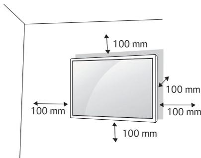
Untuk memasang monitor di dinding, pasang braket pemasangan di dinding (opsional) ke bagian belakang monitor. Pastikan braket pemasangan di dinding terpasang erat ke monitor dan ke dinding.
