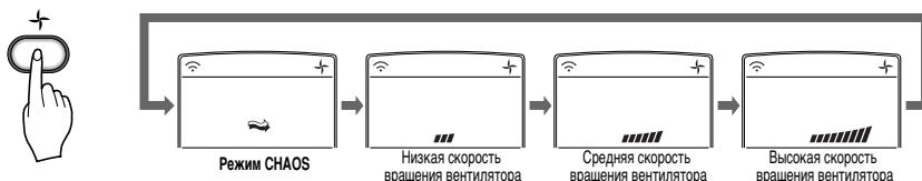
**ПРИМЕЧАНИЯ** Режим CHAOS экономит электроэнергию и предотвращает переохлаждение. В зависимости от температуры воздуха скорость вращения вентилятора автоматически меняется с низкой на высокую или наоборот.
