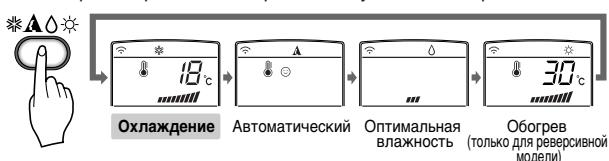
**3** Закройте крышку пульта дистанционного управления. Задайте желаемую температуру (ниже текущей). Температура может быть выбрана в диапазоне 18°C – 30°C с шагом в 1°C.
