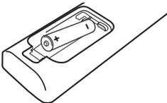
Retire la tapa del compartimento de la pila en la parte posterior del mando a distancia e inserte una pila R03 (tamaño AAA) con la polaridad correcta (+ y -).
