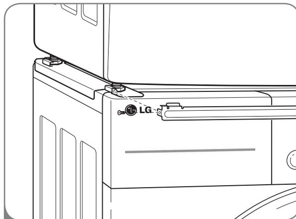
**4** Insérez le rail avant entre le bas de la sécheuse et le haut de la machine à laver. Poussez le rail avant vers l'arrière de la machine à laver jusqu'à ce qu'il entre en contact avec les butées du rail latéral. Installez les deux vis restantes pour solidement fixer le rail avant aux rails latéraux.
