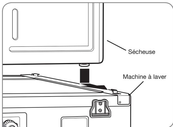
**3** Placez la sécheuse par-dessus la machine à laver en ajustant les pattes de la sécheuse dans les rails latéraux tel qu'illustré. Évitez les blessures aux doigts. Ne les pincez pas entre la sécheuse et la machine à laver. Glissez lentement la sécheuse vers l'arrière de la machine à laver jusqu'à ce que les butées des rails latéraux coincent les pieds de la sécheuse.
