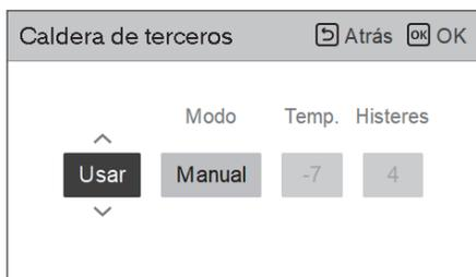
Si el modo de esta función está configurado en "Manual", puede configurar la temperatura de la caldera y la histéresis, respectivamente.
