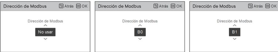
Hay 2 opciones, dirección Modbus y unidad, en esta función. Al activar la opción de dirección Modbus, usted elige una dirección (B0 o B1) o no la usa. Luego, configure el puerto y la especificación en el rango de 0000.0 ~ 9999.9 [pulso / kW] como se muestra en la figura a continuación.
