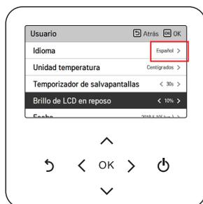
En cada pantalla con detalles del menú, como en la casilla de la imagen de la izquierda, si solo se muestra el icono ">", puede dirigirse a la pantalla de ajuste de detalles al pulsar el botón [>(derecha) o OK].
