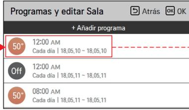
Puede consultar la información de funcionamiento del temporizador establecido (encendido/apagado, modo de funcionamiento, temperatura deseada), la hora del temporizador, el periodo y el día de la semana.
