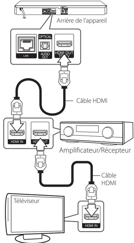
Si votre amplificateur compte un jack de sortie HDMI, branchez-le au jack d'entrée HDMI de votre télé avec un câble HDMI.
