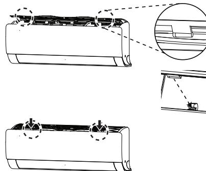
4. Vérifiez sur les côtés de la grille frontale que le filtre à air est correctement monté.
