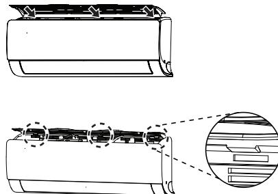
3. Enfoncer les crochets pour assembler le filtre à air.
