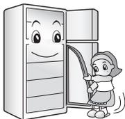
**Installez le réfrigérateur sur un plancher solide et bien nivelé.**
