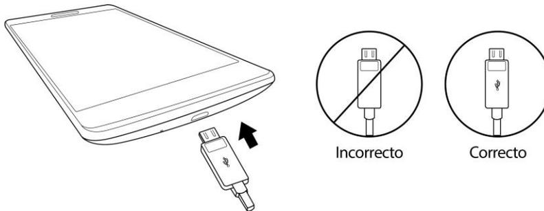
2. Inserte el extremo de mayor tamaño del cable micro USB en un puerto USB externo de su computadora.
