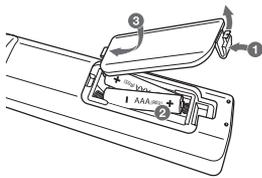
Retirez le couvercle du compartiment des piles à l'arrière de la télécommande, puis insérez deux piles (AAA) en respectant la polarité **+** et **-**.
