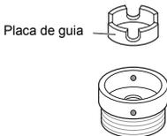
3 Empurre o adaptador na direção da extremidade da torneira para que a vedação de borracha forme uma ligação impermeável. Aperte os quatro parafusos de fixação.
