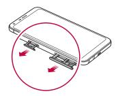
3 將 SIM 卡放入卡盤中,確保卡的金屬接觸面朝向下方。 將主要 SIM 卡放置在 SIM 卡槽 1,並把次要 SIM 卡放置在 SIM 卡槽 2。
