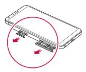
3 将 SIM 卡放入卡托盘中, 金色触点面朝下。 将主 SIM 卡放入 SIM 卡槽 1, 次 SIM 卡放入 SIM 卡槽 2.
