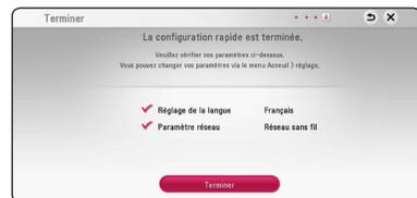
Appuyez sur **Molette (⏻)** lorsque l'option [Finish] est en surbrillance afin de terminer la configuration initiale. Si vous devez modifier un paramètre, utilisez les touches **▲/▼/◀/▶** pour sélectionner **⏮**, puis appuyez sur **Molette (⏻)**.
