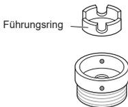
3 Schieben Sie den Anschluss auf das Ende des Wasserhahns, so dass mit der Gummidichtung eine wasserdichte Verbindung gebildet wird. Ziehen Sie die vier Befestigungsschrauben an.
