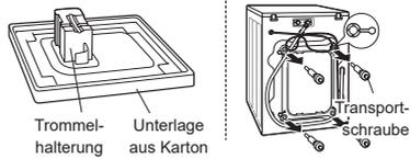
Transportschrauben und Trommelhalterung entfernen.
