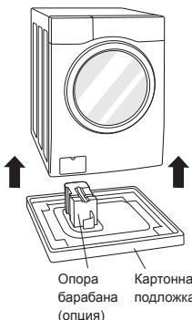
**2** Снимите болтовые соединения.
