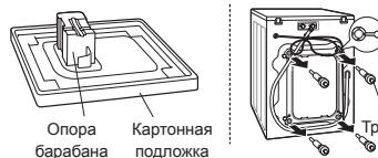
Снимите транспортировочные болты и опоры.
