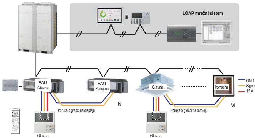
\* U slučaju spajanja sa standardnom unutrašnjom jedinicom i jedinicom za ulaz svežeg vazduha, odvojite jedinicu za ulaz svežeg vazduha od standardnih jedinica. (N, M ≤ 16)
