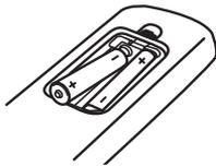
Quite la cubierta de las baterías de la parte posterior del control remoto e inserte dos baterías (tamaño AAA) haciendo coincidir **+** y **-** correctamente.
