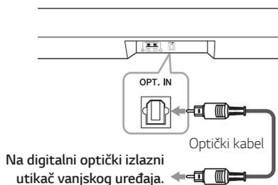
1. Priključite OPT. IN priključak na uređaju na optički izlaz na vašem televizoru (ili digitalnom uređaju i sl).
