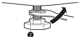
**4** Verifique si todas las tuercas de seguridad de la parte inferior de el electrodoméstico están aseguradas correctamente.
