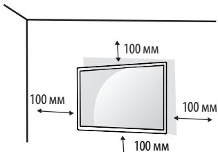
Ако планирате да монтирате телевизора на стена, закачете конзолата за окачване на стена (допълнителни части) към гърба на телевизора.
