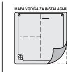
3. Načinite rupu prečnika 6 mm i dubine 30-35 mm prilikom bušenja rupe za pričvršćivanje.
