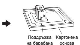
Премахнете болтовете за предпазване при превоз и опора на барабана.
