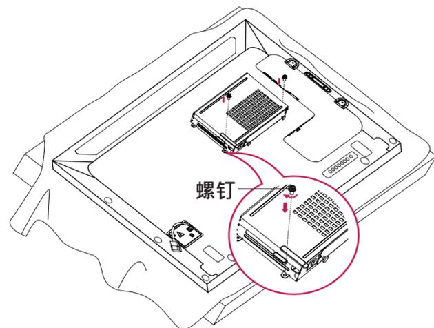
6 将 OPS 播放器 (另售) 插入 KT-OPS\* 下部的孔中，在下部拧紧提供的两个螺钉，完成安装。
