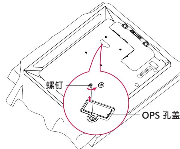
2 掀开 OPS 孔盖左侧 (圆角部分)。取下机盖。
