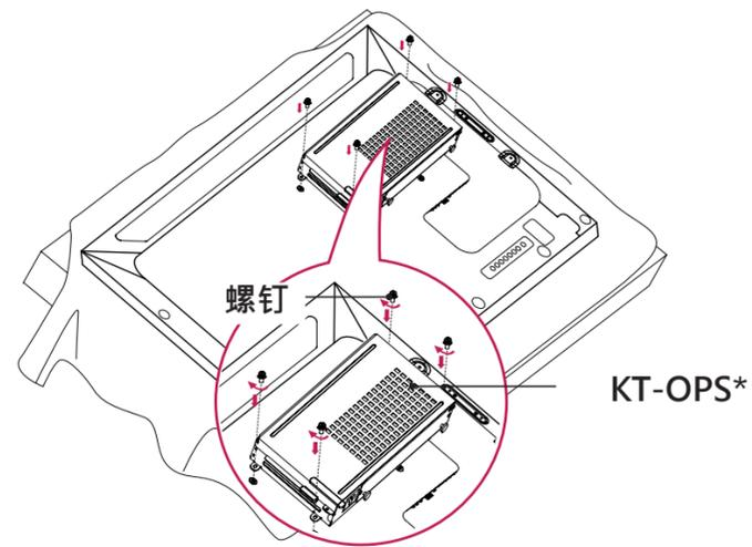
4 打开 KT-OPS\* 顶盖，用提供的电缆连接显示器内部的接口和 KT-OPS\* 上的接口。
