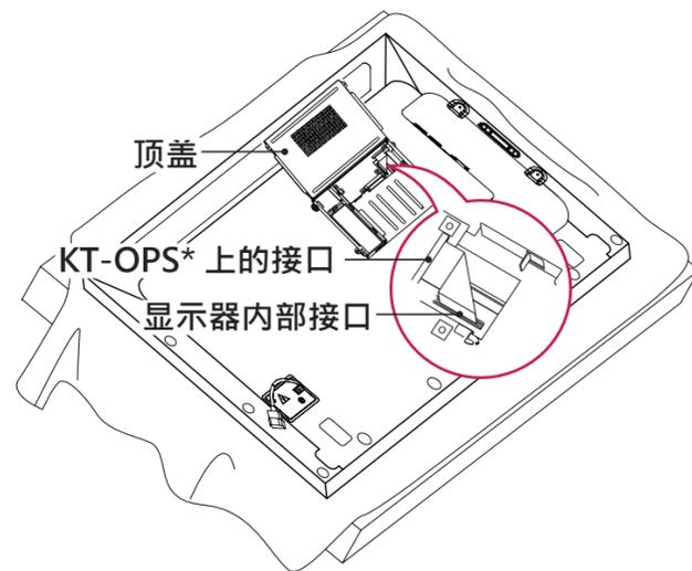
5 合上 KT-OPS\* 的顶盖，用提供的两个螺钉分别固定左侧和右侧。
