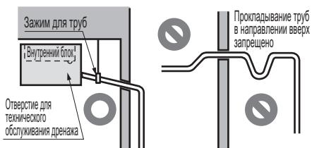
**Материал для теплоизоляции: пенополиэтилен толщиной не менее 8 мм.**
