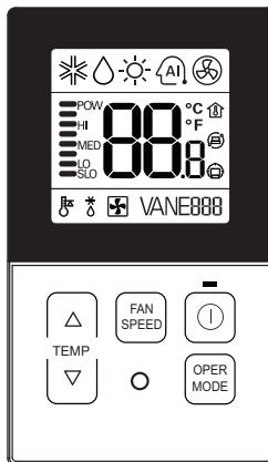
**1** Если необходимо определить режим настройки программы установки, нажмите кнопку повышения температуры и кнопку режима работы одновременно и удерживайте их нажатыми в течение пяти секунд.
