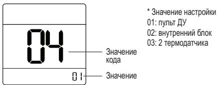
**3** При нажатии кнопки ( $\text{①}$ ) будет задано настроенное в настоящее время местоположение термисторного датчика.
