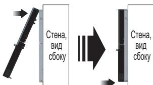
Снимите пульт ДУ, вставив отвертку в нижние отверстия и повернув ее, чтобы снять пульт с монтажной панели.
