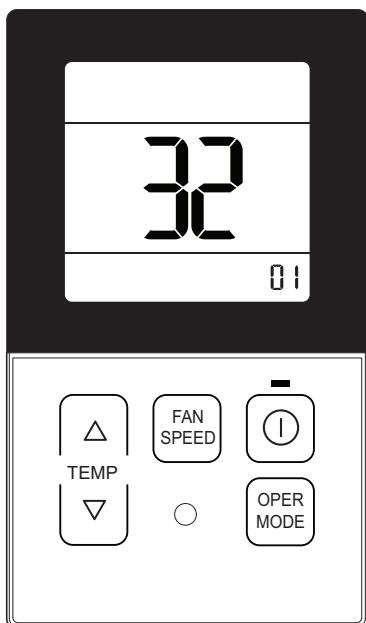
**1** При одновременном нажатии кнопок ( $\triangle$ ) и ( $\text{OPER MODE}$ ) более 3 секунд система войдет в режим настройки программы установки.
