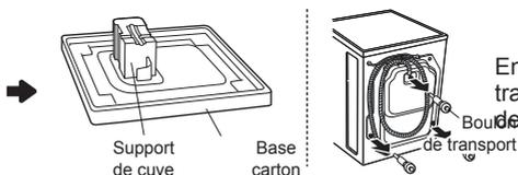
Enlever les boulons de transport et le support de cuve.
