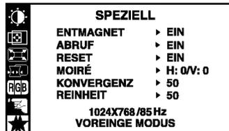
**ENTMAGNET** Dient der manuellen Entmagnetisierung des Bildschirms, um falsche Darstellung der Bilder oder Farben zu vermeiden.
