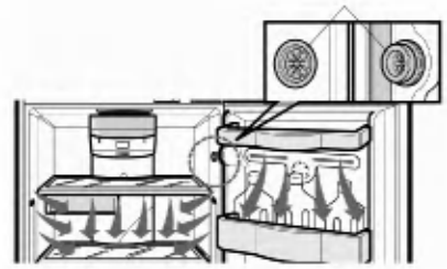
ช่องจ่ายอากาศเย็น
