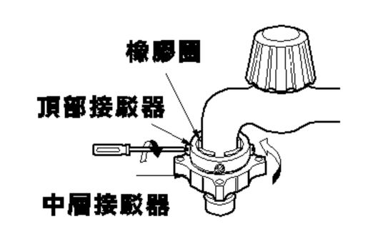
3. 將供水管接駁至中層接駁器, 將托盤向下推。
