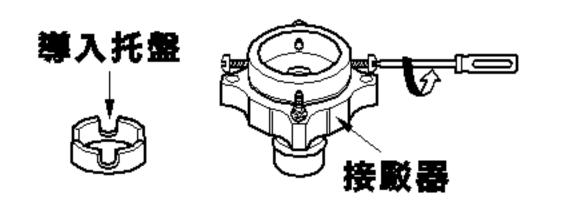
2. 將頂部接駁器向上推, 直至橡膠圈緊貼水喉。 將四顆螺絲鎖緊。
