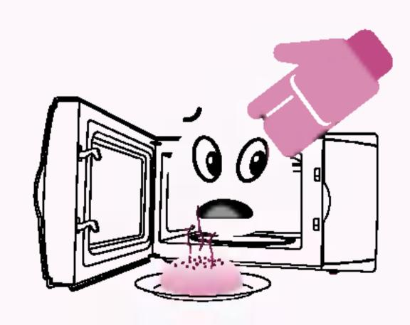
若微波炉的电源线损坏,必须使用专用软线或从厂家、维修部购买专业组件进行更换。切记,不可用湿手触摸电源插头。
