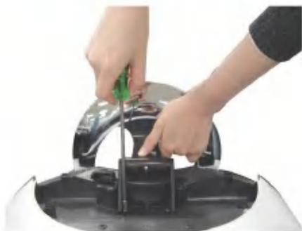
2. Αποσυνδέστε τη βάση στήριξης χρησιμοποιώντας ένα κατασβίδι όπως φαίνεται στην εικόνα.
