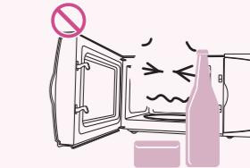
金属包装的液体请不要在微波炉内加热, 否则会发生打火现象和爆炸的可能。
