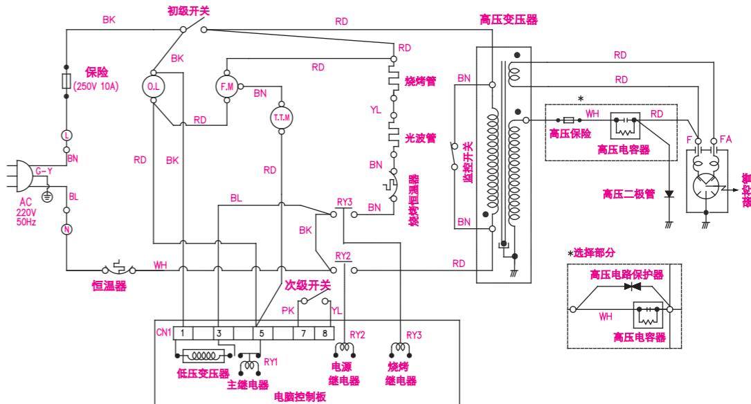
\*注: 炉门打开时 O.L:炉灯 T.T.M:转盘电机 F.M:风扇电机 BN=棕色线 RD=红色线
