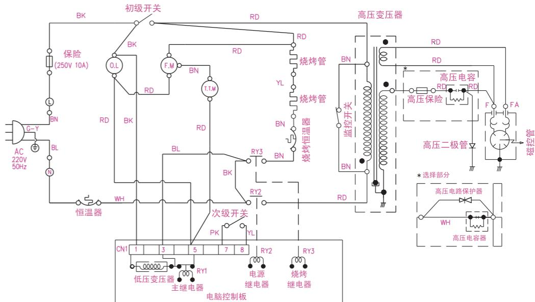
\*注: 炉门打开时 O.L:炉灯 T.T.M:转盘电机 F.M:风扇电机 BN=棕色线 RD=红色线
