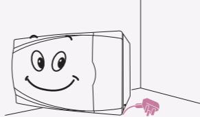
由于微波炉工作电流大, 应使用专用插座, 不要同其他电器共用(特别是电冰箱类), 否则容易造成电器过载, 损坏电器。
