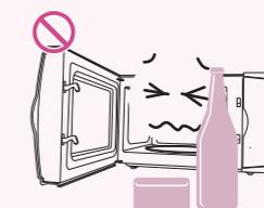
金属包装的液体请不要在微波炉内加热，否则会发生打火现象和爆炸的可能。
