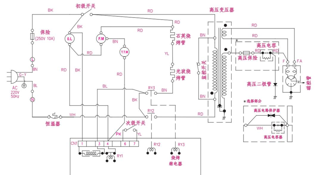
\*注: 炉门打开时 0.L:炉灯 T.T.M:转盘电机 F.M:风扇电机 BN=棕色线 RD=红色线
