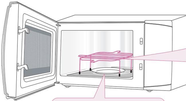
烧烤架: 请将烧烤架按照图示方式放在微晶玻璃上, 并向内推至白色保护套与炉腔圆形部分接触, 保证烧烤架承物面上的金属条横向放置, 同时烧烤架的四个支脚应放在微晶玻璃上。请注意不要让烧烤架的金属部分接触炉腔, 也注意不要将支脚置于微晶玻璃外的金属部分上, 以免产生火花。
