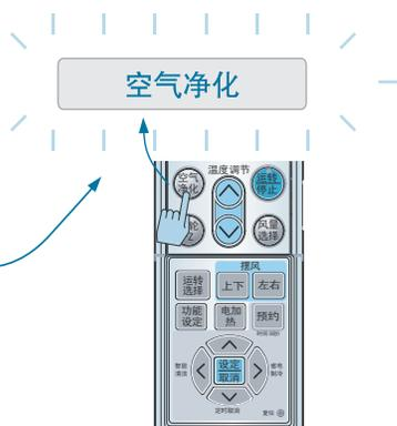
① 按下“空气净化”按钮，进入空气净化运转方式。
