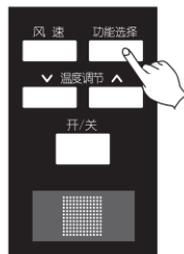
1. 按下“开/关”按钮后，选择制热运转方式，制热运转和电加热运转将同时开启。
