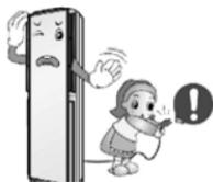
清扫前请务必切断主电源，不要直接用水冲洗空调器，清洗时请勿使用稀释剂和石蜡等强力清洁剂。
