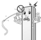
电器部位应该避免浸水，如浸水请立即切断电源并与维修人员联系。
