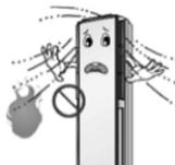
禁止可燃器具放置在空调可以吹到的地方在与可燃器具同时使用时，请注意通风。
