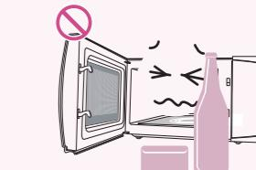
如果微波炉门或门封发生损坏, 密封硅胶发生破损, 以及微晶玻璃板发生破裂, 请立即停止使用, 直到有资格认可的维修人员进行检修后才可以使用。
