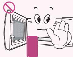
微波炉门封条、炉门、门闩、门轴等要注意保持清洁，并注意当门上夹有异物时禁止使用微波炉。
