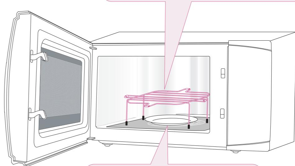
玻璃盘或陶瓷盘：在进行烧烤/组合烧烤时，请在烧烤架下方放置一个**玻璃盘或陶瓷盘**，用来接取烧烤时滴落的油等。
