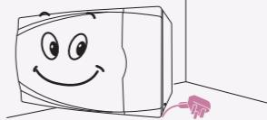
由于微波炉工作电流大，应使用专用插座，不要同其他电器共用（特别是电冰箱类），否则容易造成电器过载，损坏电器。
