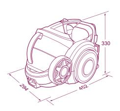
型号: V-KC902HE 额定电压: 220V~ 50Hz 额定功率: 1800W 最大功率: 2000W 吸率: 300W 净重: 6.5 Kg 外形尺寸: 294mm x 452mm x 330mm 本产品执行标准: GB4706.1-2005 GB4706.7-2004 GB17625.1-2003 GB4343-2003
