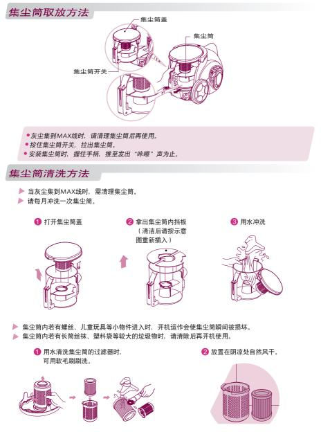
集尘筒过滤器被堵塞后,机器发出异常噪音,然后停止,此时请清理集尘筒内的过滤器,然后 重新开启机器使用。
